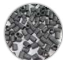
NOSIČE istenie odpadových vôd sa vykonáva pohybom nosiča, na ktorom sú prilepené mikroorganizmy
